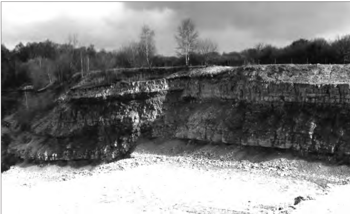
FIGUUR 1 DE STEENGROEVE VAN WINTERSWIJK. OPNAME VAN DE ZUIDELIJKE WAND MET ONGEVEER IN HET MIDDEN EEN GROTE BREUK DOOR HET GEHELE KALKPAKKET. [FOTO: HENK OOSTERINK]
