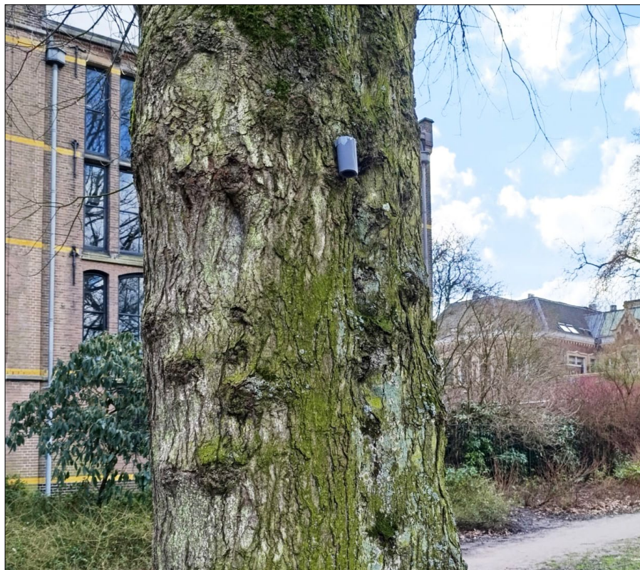
▲ Sensor om het microklimaat te meten van mossen en korstmossen die op deze boom groeien in het Van der Werffpark, Leiden. (Tim Claerhout)
